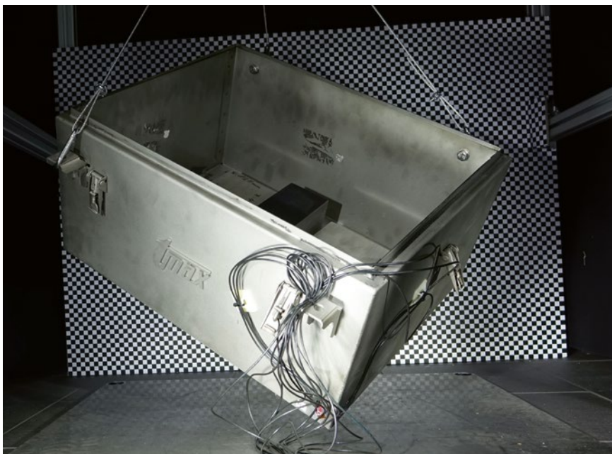
BILD 5 Fallversuch an einem Batteriegehäuse (© Thermamax)
