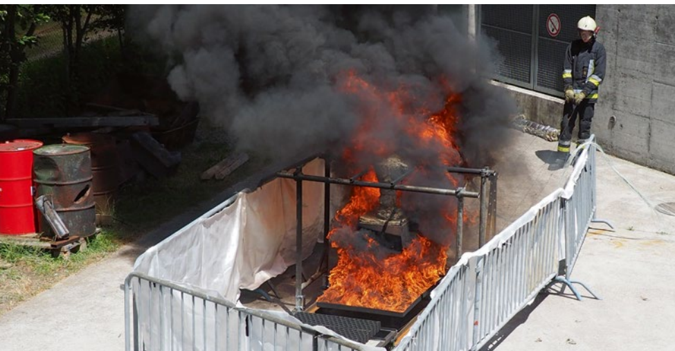
BILD 2 Brandversuch nach ECE R100 (© Thermamax)
